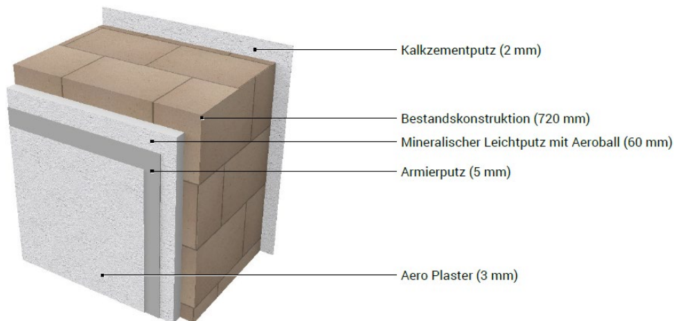
Abbildung 9: Raum 1.11 – ADT Aero Ball Dämmputz
