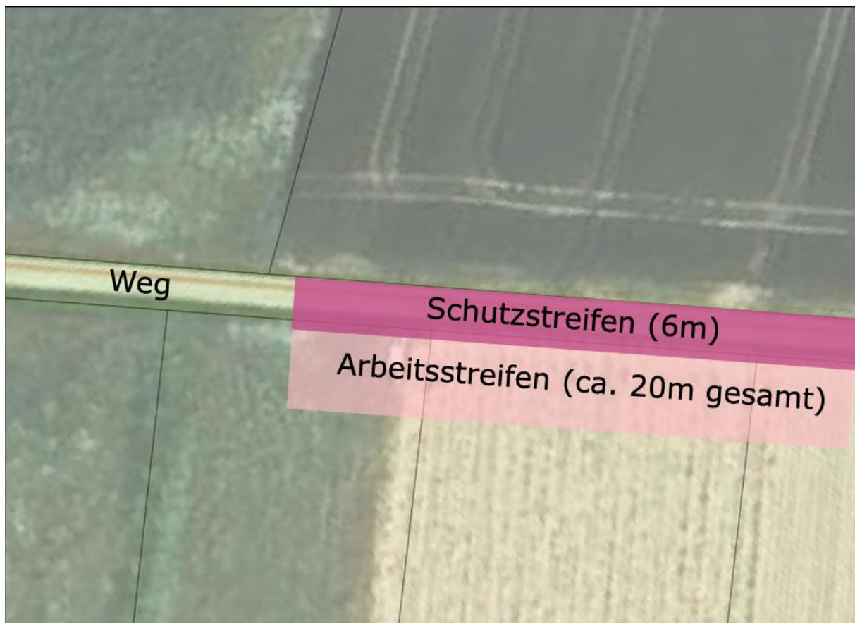
Abbildung 8: Schutzstreifen und Arbeitsstreifen während der Bauzeit
