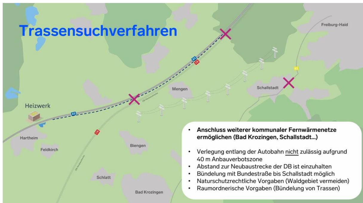
Abbildung 4: Trassensuchverfahren für die Wärmeleitung
