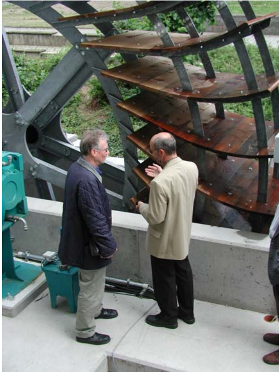
Bild 8 und Bild 9 : Holzbeplankung und Schaufelform nach der Bauart von Zuppinger
