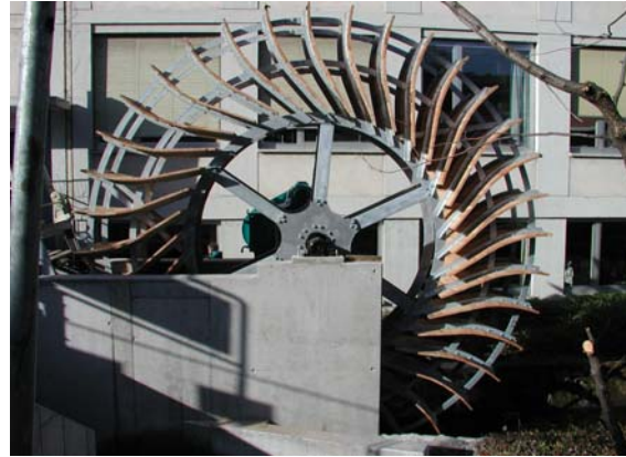
Bild 8 und Bild 9 : Holzbeplankung und Schaufelform nach der Bauart von Zuppinger
