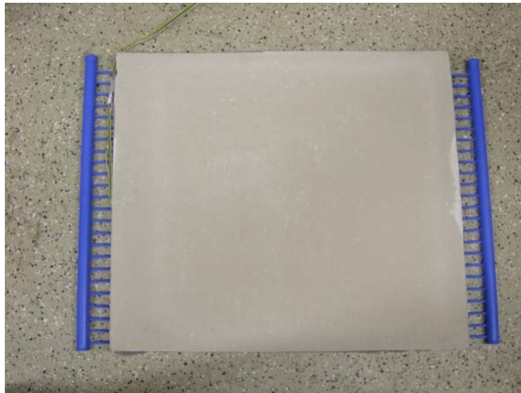
Bild 16: Testplatte einer Fußbodenheizung mit integriertem PCM und einer Kapillarrohrmatte für die Durchströmung mit Wasser.
