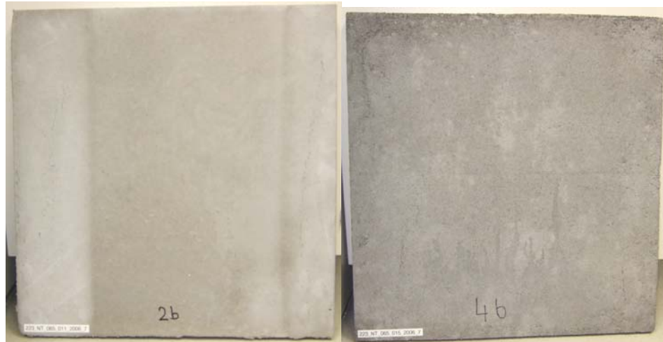
Bild 6: Estrichproben für die Plattenapparatur. insgesamt wurden 7 Platten (50x50 cm) und unterschiedlichen PCM-Gehalten und Graphitfaserlängen für die Wärmestrommessung gefertigt
