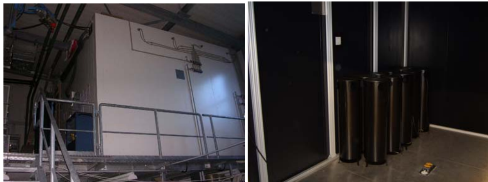
Bild 19: Außenansicht (links) und Innenansicht (rechts) der Testkammer des Fraunhofer ISE zur Vermessung von Heiz- und Kühlflächen unter kontrollierten Bedingungen.
