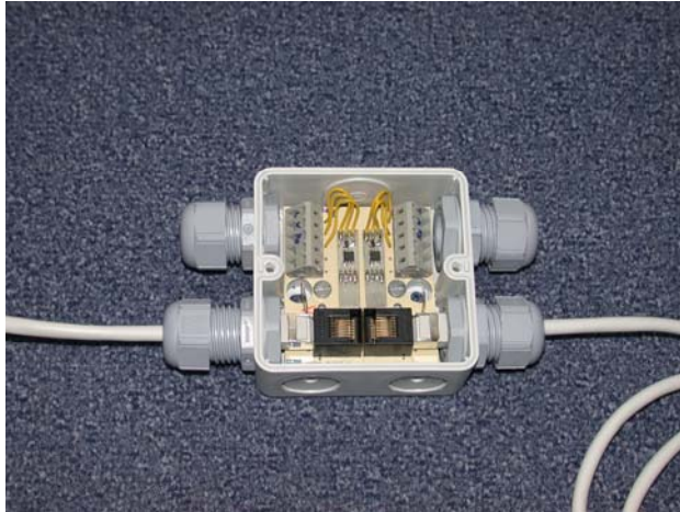
Abbildung 2.5.4: Detailansicht eines Moduls mit 2 analogen Ausgängen
