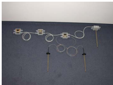
Abbildung 2.5.2: Messkette mit Temperatur- und Feuchtefühler, sowie digitalen und Analogen Ein- und Ausgängen.
