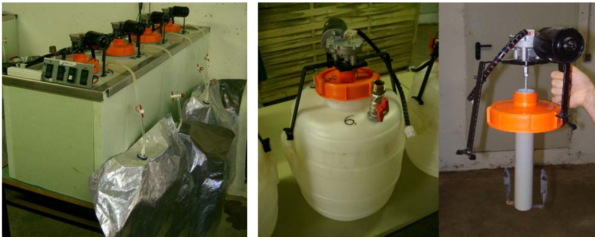
Abb. 6: Wasserbad mit Gärbehältern, Gärbehälter, Rührwerk (von li.).
