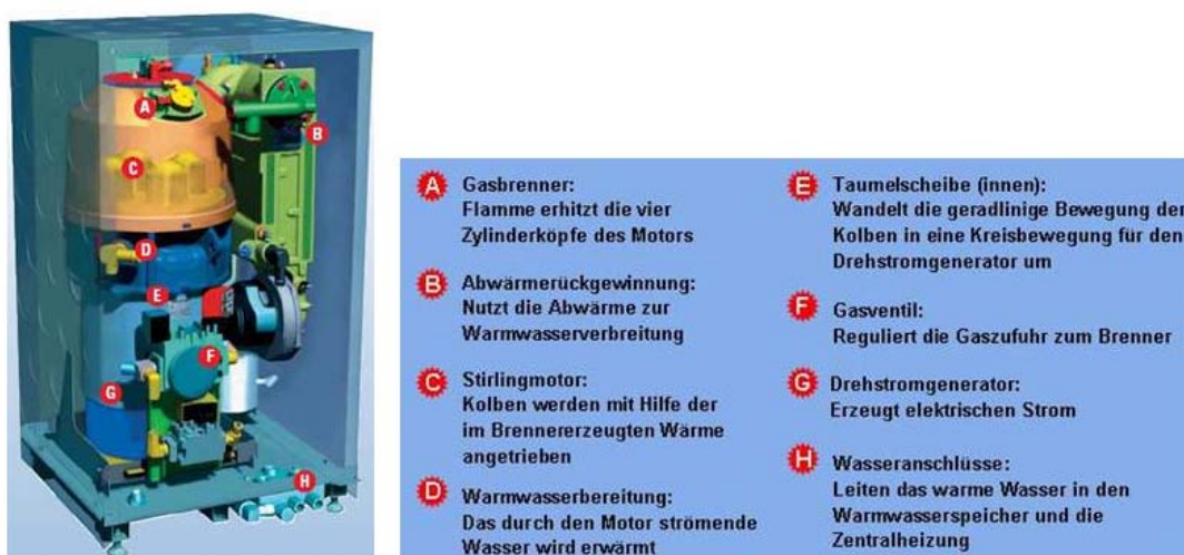
Abbildung: Schnittmodell Typ MK Vb, Bj. 2006, Quelle: WhisperTech.
