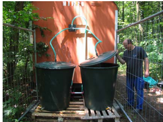
Bild 5: Tanks zur Aufnahme von Regenwasser für die Bestimmung der Sinkgeschwindigkeit
