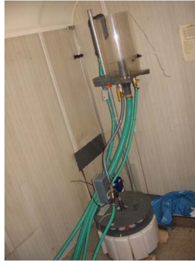
Bild 3: Behälter zur Entnahme von bis zu 12 Proben in einem By- Pass Strom
