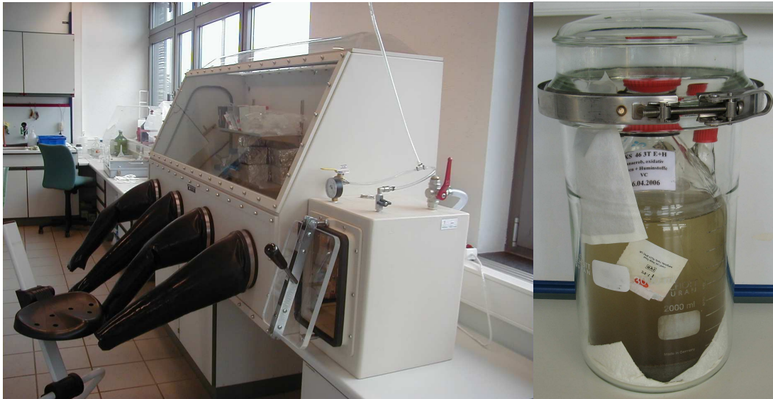
Abb. 5: Anaerobbox und Inkubation der Ansätze in Anaerobgefäßen
