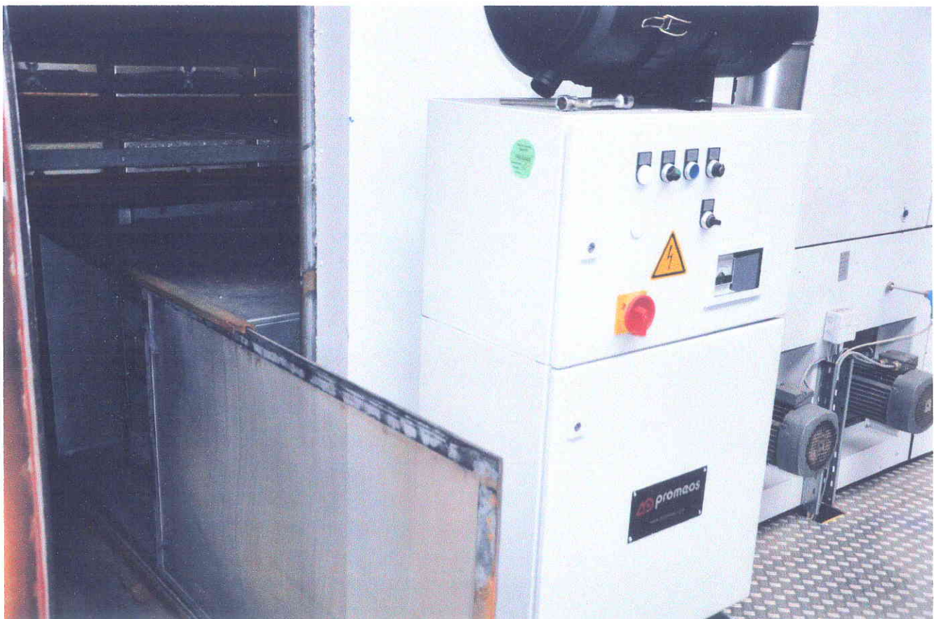
Luftleitkanal mit montiertem Brennersystem/ Versorgungseinheit
