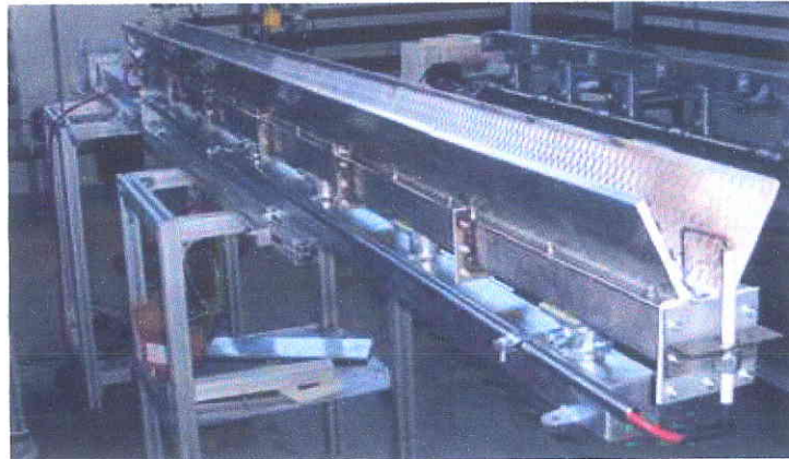
Bild 1 und 2: Linienbrenner für einen Textiltrockner
