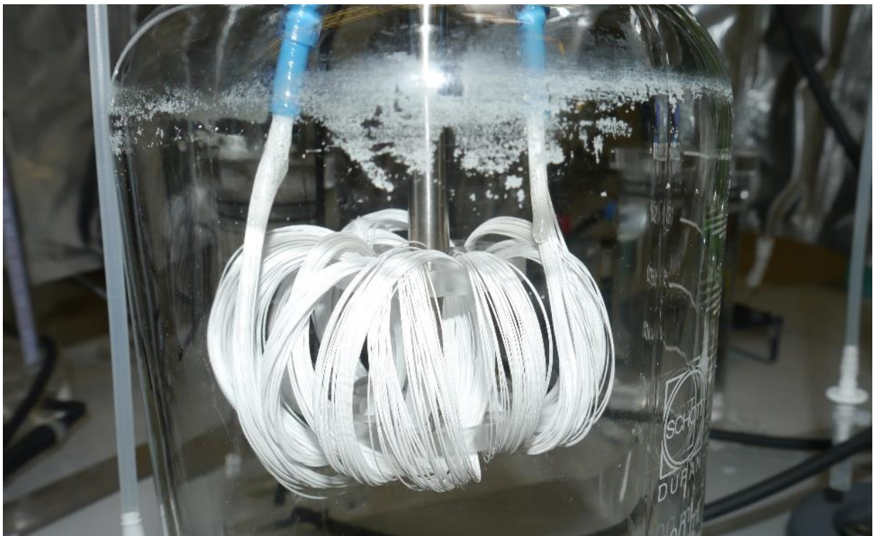
Abbildung 6 Laborteststand C – Membranmodul.
