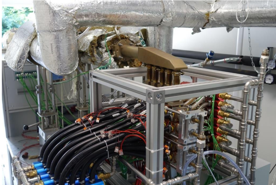
Abbildung 9: Integration des 5-strängigen TEG-Aufbaus am Heißluft-Prüfstand des Fraunhofer IPM (2016)
