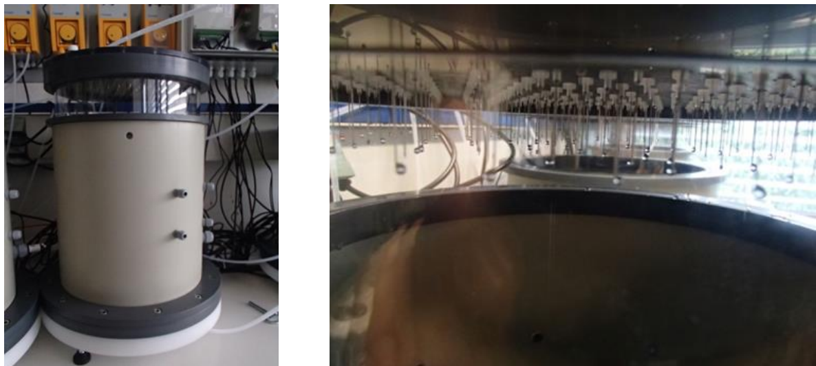
Abbildung 2: Links: Ein Laborlysimeter in Betrieb im Bodenlabor des TZW, Rechts: Detailaufnahme der Beregnungskanülen.
