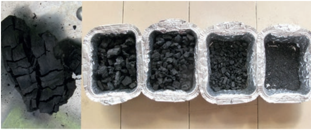
Abb. 4: Links im Bild ein verkohlter, 10 cm großer Rebstockabschnitt kurz vor dem Auseinanderbrechen. Die Siebung zur Größenbestimmung ergab zu 76 % Körner mit 1 bis 3 cm Kantenlänge, der Rest war kleiner als 1 cm (2 Schalen rechts)
