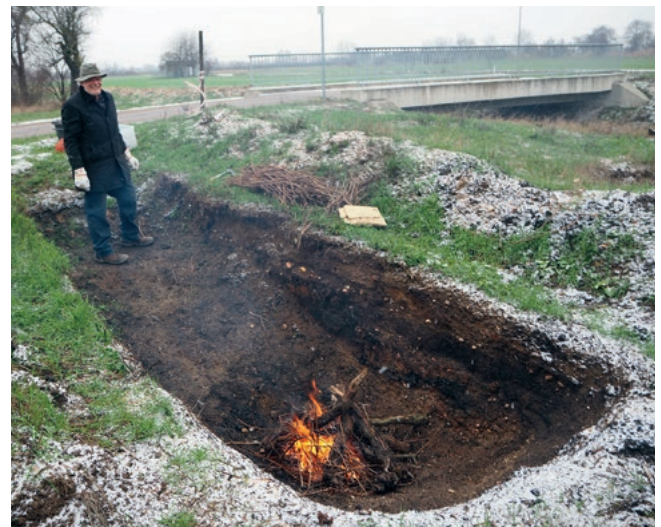
Abb. 2: In der Vorrecherche wurde Stockholz zu einer stationären Erdgrube bei Karlsruhe gebracht und am 11. Januar probeverkohlt (Dr. Armin Siepe, Büro SchwarzErde)
