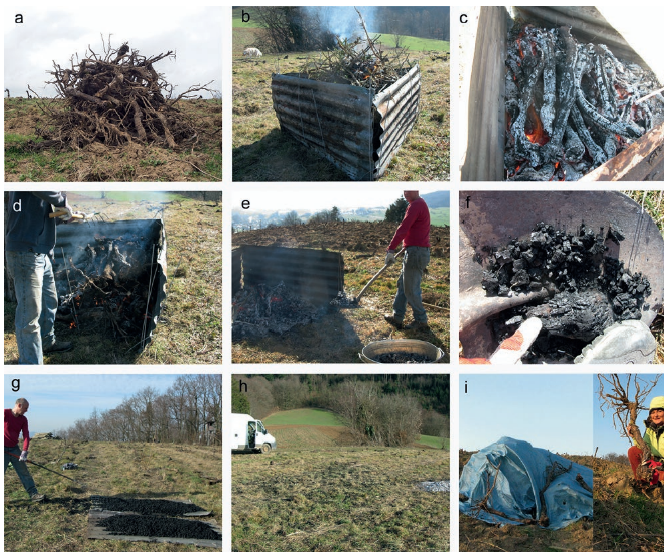
Abb. 3: Abfolge der Probeverkohlung per Wellblech-Meiler. a: Knapp 1 m 3 Rebholz von 1,5 Ar stehen bereit; b: Drei Wellbleche zu einem Wall aufgebaut fassen das Material; Reisig wird oben aufgeschichtet und angezündet; c: Nach etwa 2 h ist die Hitzeentwicklung komplett, die meisten Stöcke glühen; d: Mit der Gabel können noch nicht erfasste Stöcke besser ausgerichtet und der Haufen kann verdichtet werden; e: Das seitliche Wegschaufeln rettet die Kohle vor der weiteren Veraschung und hebt dadurch die Kohleausbeute; abgelöscht wird im Wasserbad; f: In Partikel zerfallene Rebstockkohle, daneben ein noch nicht durchgeglühter Stockabschnitt; g und h: Die Bleche eignen sich gut zum Kühlen und Verteilen der Kohle; i: Im übrigen Feld schließen sich Trocknungsversuche an, in sehr feuchten Perioden unter Planen
